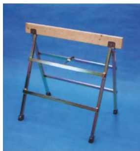
■ Art. nr 20 Uppläggningsbock Höjd 830 mm, Bredd 900 mm, Vikt 8 kg Max belastning 400 kg
